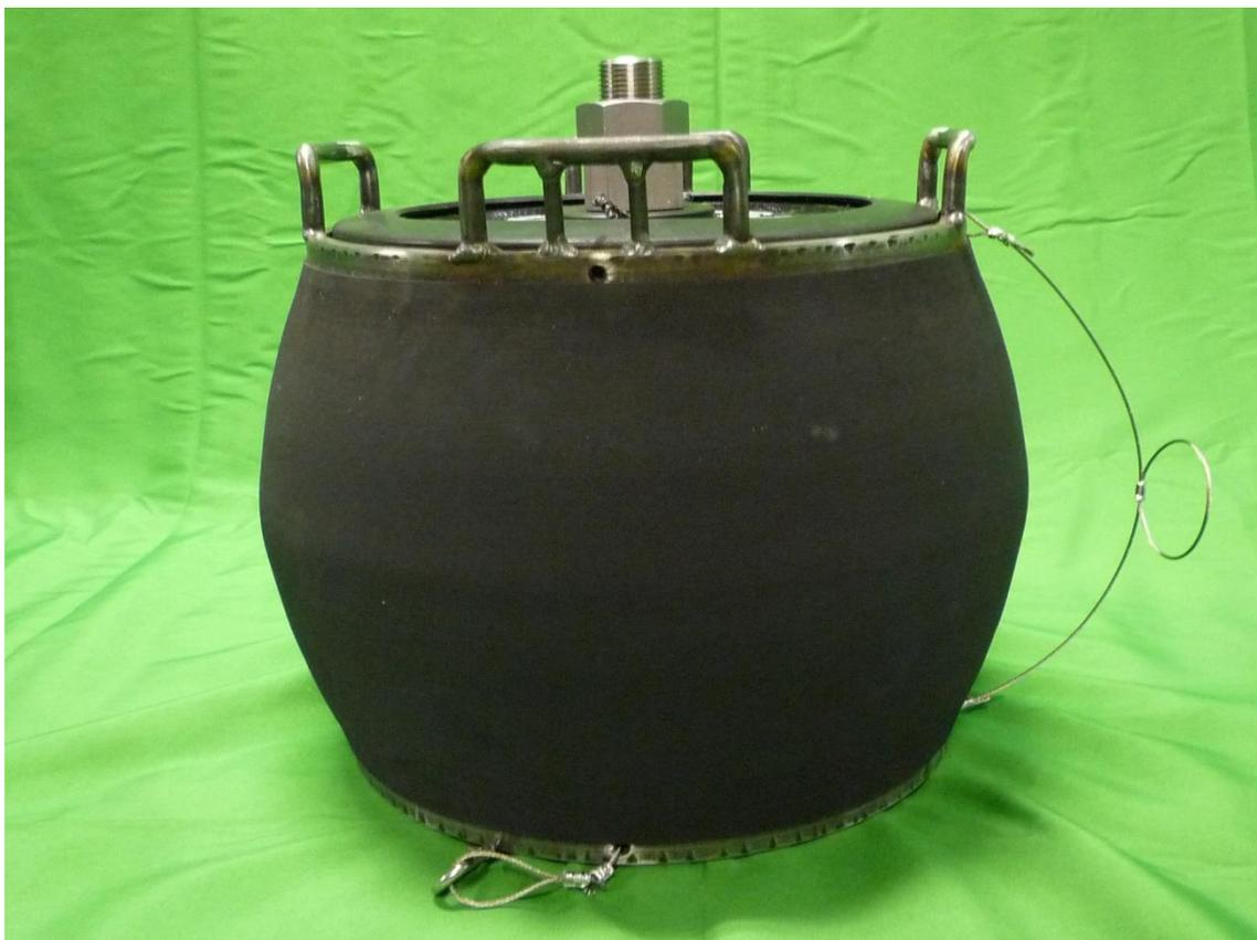
橋脚衝撃振動試験用の最大約 70kg の重錘です。外周をゴムで覆っています。分割して運搬できる組立式です。以下の写真のように、約 7.5kg の円板プレート 6 枚、円筒金具（約 20kg）、鋼棒ボルト（ナット、ワッシャ）に分解できます。
